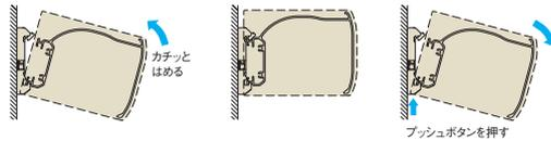
カバーの下側をブラケットに差し込み、さらに上側をはめ込みます。
