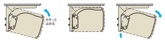
カバーの下側をブラケットに差し込み、さらに上側をはめ込みます。
