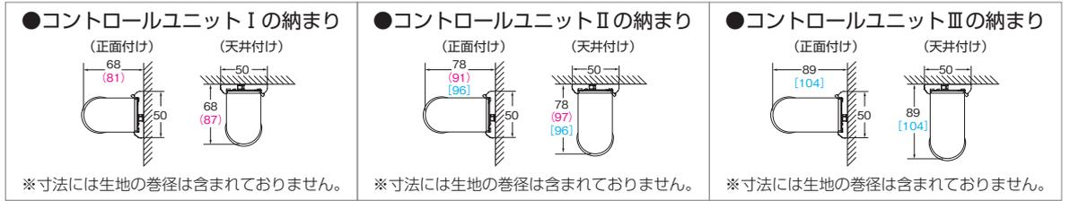
※ ( ) 内数値はスマートコード式のスマートユニット部を含んだ寸法。正面付けの場合、スマートユニットの上端はブラケット上端位置より6mm大きくなります。
