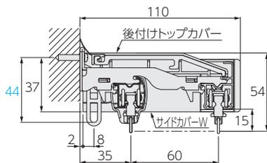
後付けトップカバー取付け必要寸法
