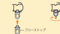
①カーテンエンドの位置にセットする ②フックを90度回転して固定
