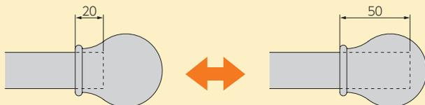
レールののみ込み寸法は最小20mm ~最大50mmまで調整可能。
